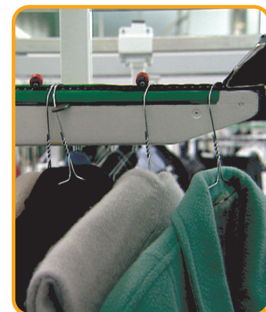
linee di accumulo con separatori
